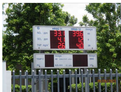
ภาพที่ 2-4 จอแสดงผลการตรวจวัดคุณภาพอากาศจากปล่อง ระบายบริเวณหน้าโรงไฟฟ้า
