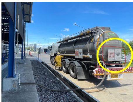
ภาพที่ 2-28 การติดเครื่องหมาย ป้ายวัตถุอันตราย และเบอร์โทรศัพท์ที่ตัวถังของรถบรรทุกสารเคมี
